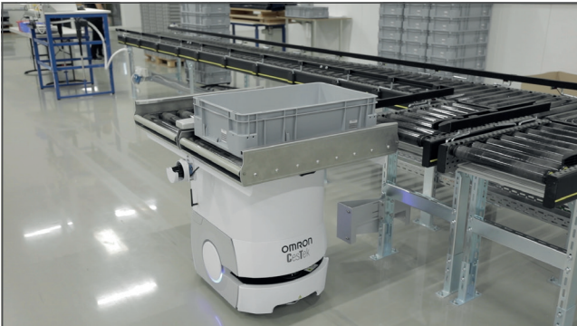
OMRON LD robotlar taşıyıcı bantların yerini aldı ve daha esnek bir üretim ve lojistik ortamı sağladı.
