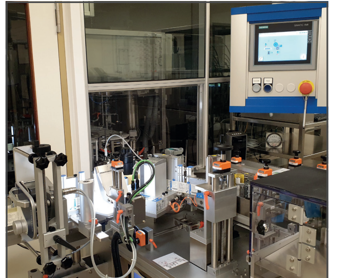
FHV7 serisi akıllı kamera, gelişmiş görsel denetimlere yönelik aydınlatma ve görüntü işleme işlevine sahiptir.
