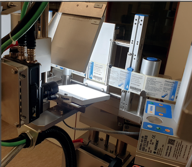
FHV7 denetim sisteminin yardımıyla, Steierl-Pharma'daki HERMA etiketleme makinesi, ilaç koduna göre etiketin kimliğini kontrol eder ve parti ile son kullanma tarihini doğrular.
