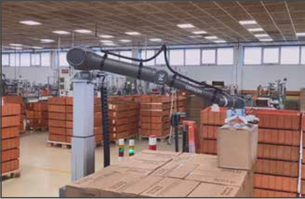
Yeni RC-1 robot, 1300 mm'ye kadar ulaşabilir ve 14 kg'a kadar yük taşıyabilir.
