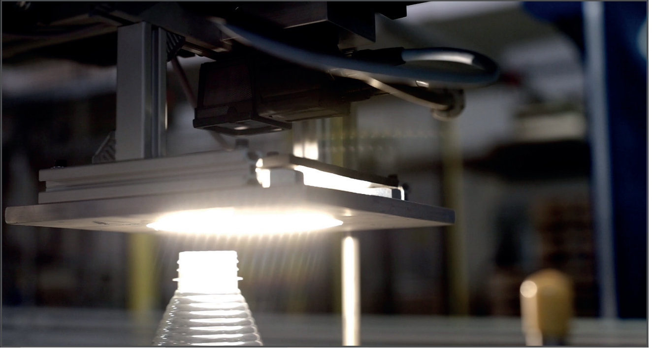
OMRON sistemi üretim hattında kullanılıyor ve herhangi bir kusuru tespit edebilmeleri için farklı açılarda ayarlanmış ışıklar ve kameralar içeriyor.
