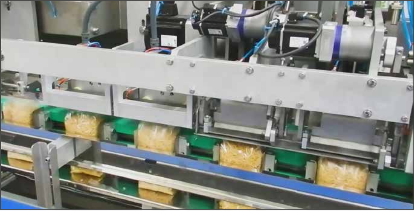
Martini MCRS-VD, yastık başına dakikada 180 makarna paketi ve 160 adet çift karelik paket üretebilir.
