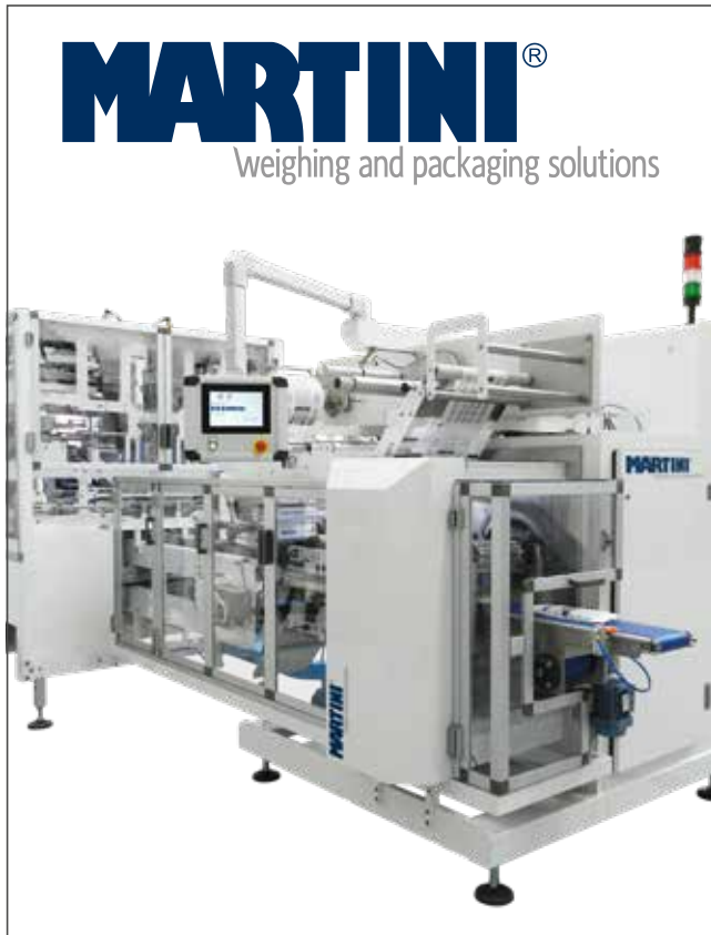
Martini'nin yeni HFFS (Yatay Form, Doldurma ve Mühürleme) sistemi üretimi %10 hızlandırdı. Bu başarıda Omron'un yeni tekli NJ501-1400 Sysmac Makine Kontrolörünün de rolü var.
