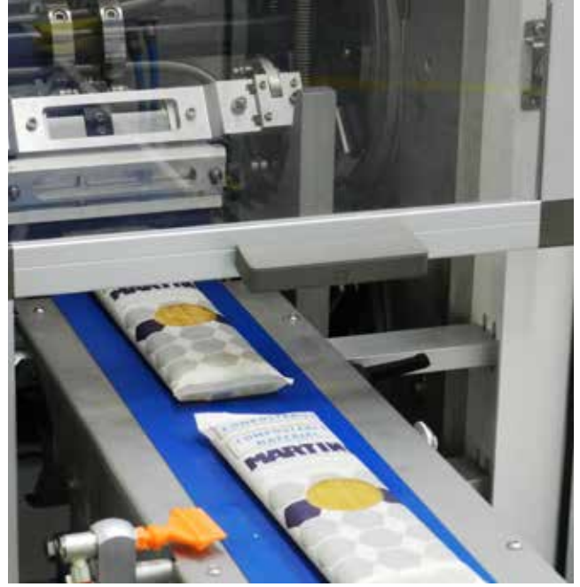
Yeni sistem sayesinde, üretim süreci farklı uzun kesim makarna gruplarını paketleyecek şekilde hızla değiştirilebiliyor.
