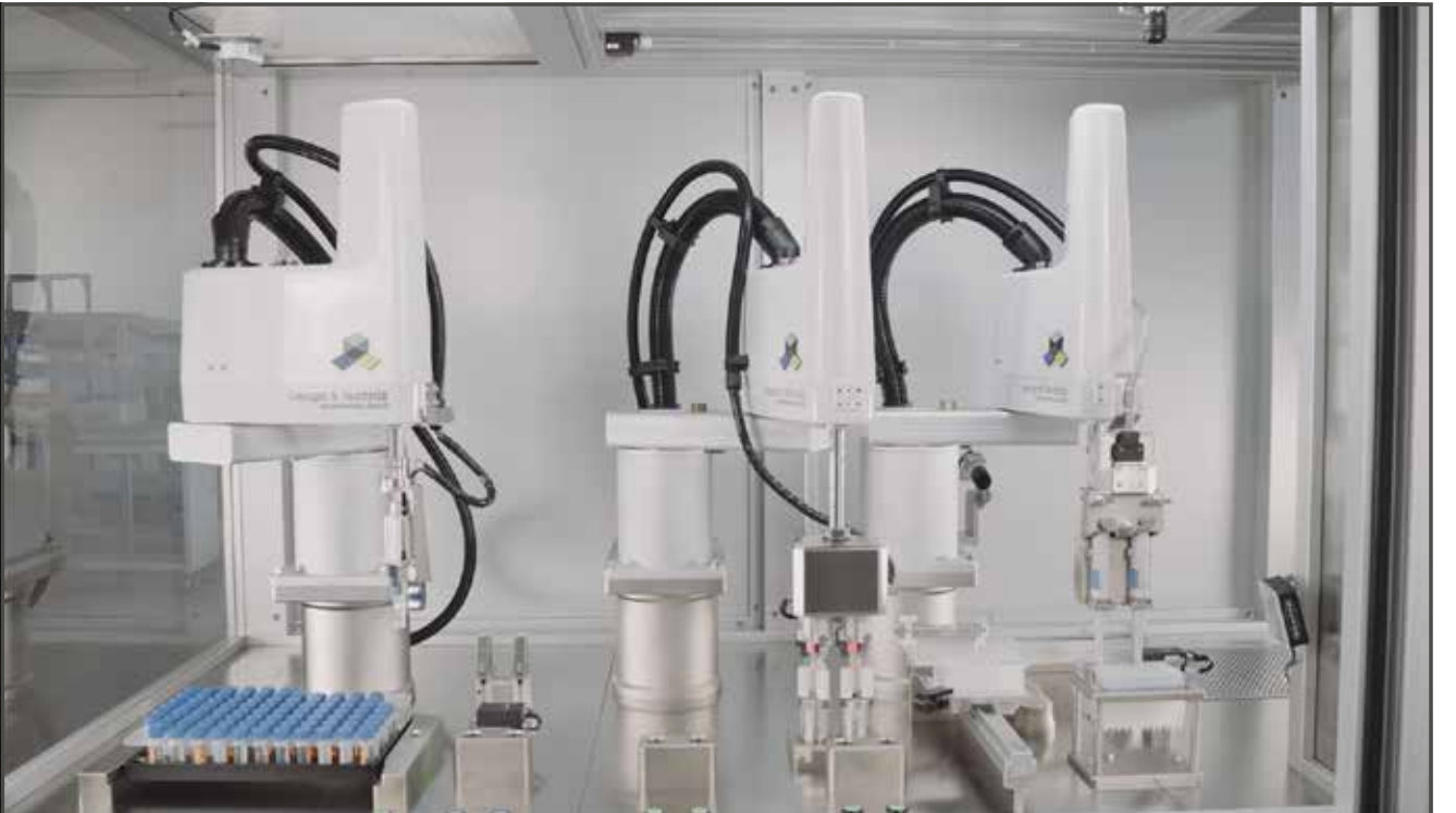
Üç şirket bu doğrultuda, numunelerin aktarımında temassız taşıma için OMRON Cobra 450 robotunu kullanan PT600 laboratuvar işleme sistemini geliştirdi.
