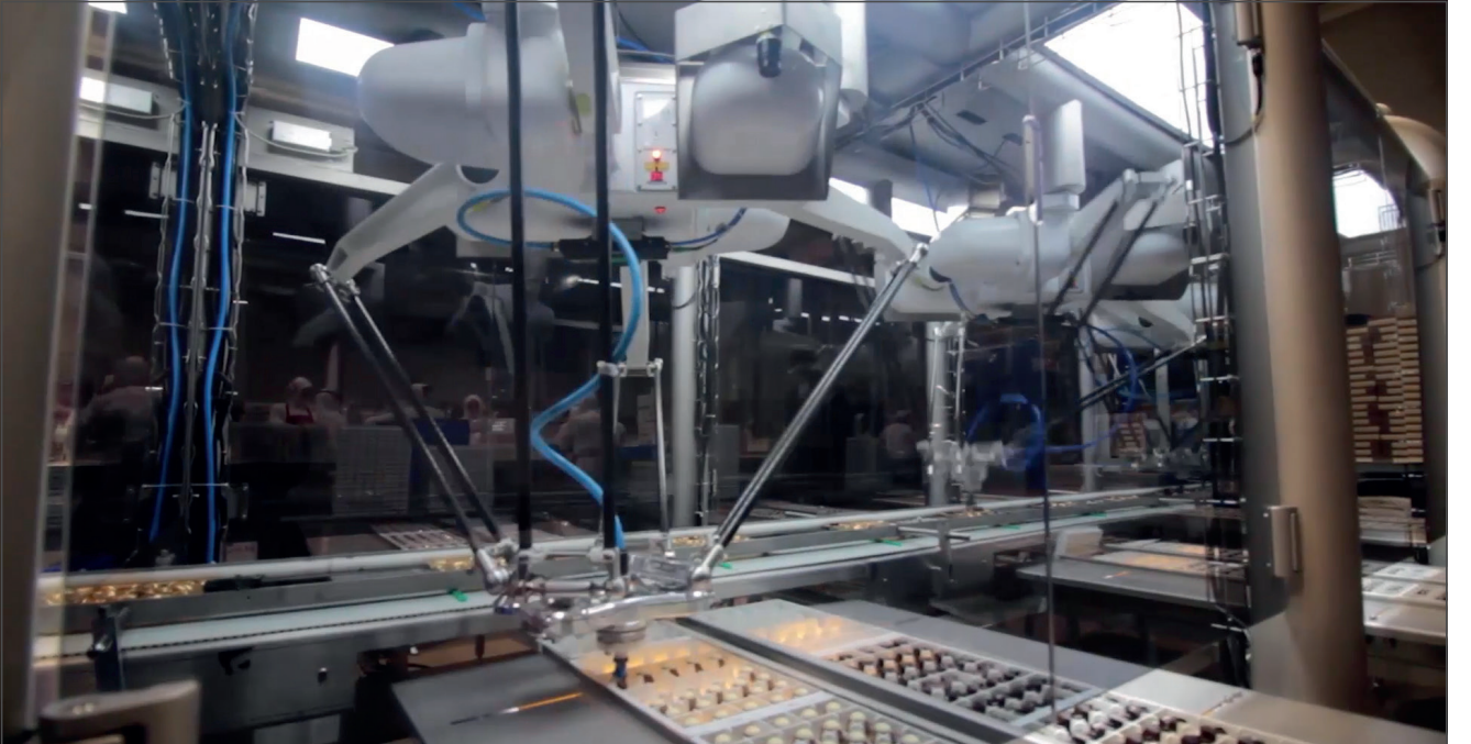
Üç robot görsel denetim, emniyet ve robotik sistemler içeren entegre bir sistemin parçası olarak birbirleriyle senkronize bir şekilde çalışır.
