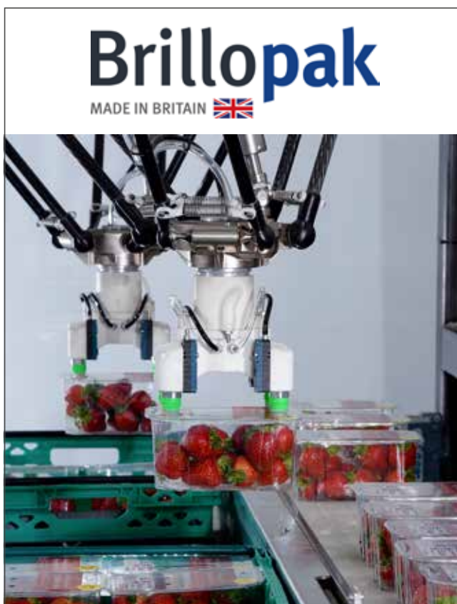
Brillopak har utvecklat en unik lösning med individuell paketering som lastar varje tråg på rätt plats i lådan.
