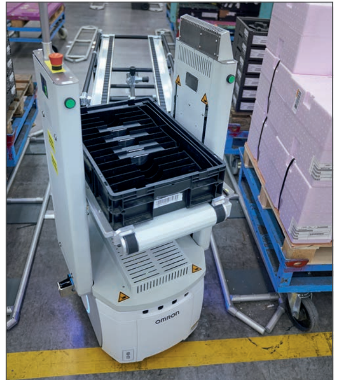
Доставка срочных мелких деталей осуществляется с помощью небольшой версии STR – miniSTR на базе мобильного робота Omron LD.
