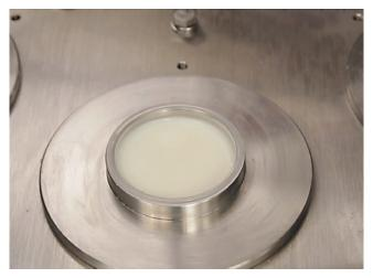
A RMD Nano é uma máquina de embalagem rotativa para vários formatos que realiza tarefas de doseamento, fecho e aplicação de coberturas. A solução anti-salpicos aplicada pelo nosso Engenheiro de Aplicações de Campo permitiu um funcionamento 30% mais rápido da máquina sem qualquer possibilidade de ocorrência de salpicos e derrames de produtos.
