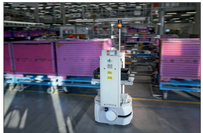
Estes robôs móveis autónomos estão equipados com uma torre de transporte, um dispositivo de manuseamento de carga ajustável em altura desenvolvido pelo integrador de sistemas cts GmbH.
