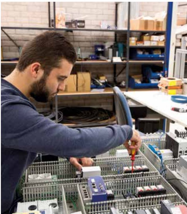
Technologia Push-In Plus znacznie ułatwia i przyspiesza podłączenie szafek sterowniczych.
