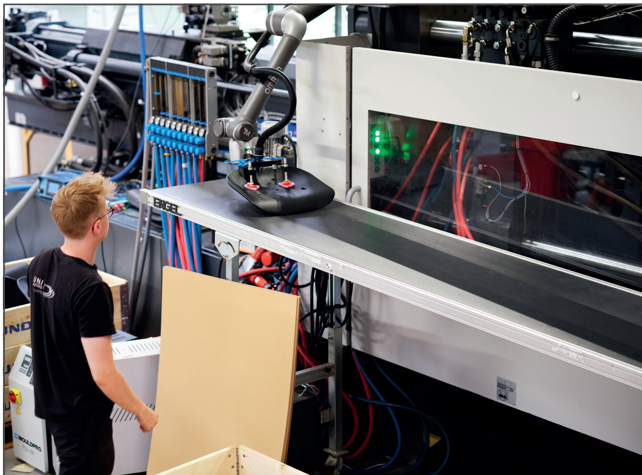
Za pomocą zintegrowanego systemu wizyjnego kobot sprawdza położenie etykiety na zakrzywionym tworzywie sztucznym.
