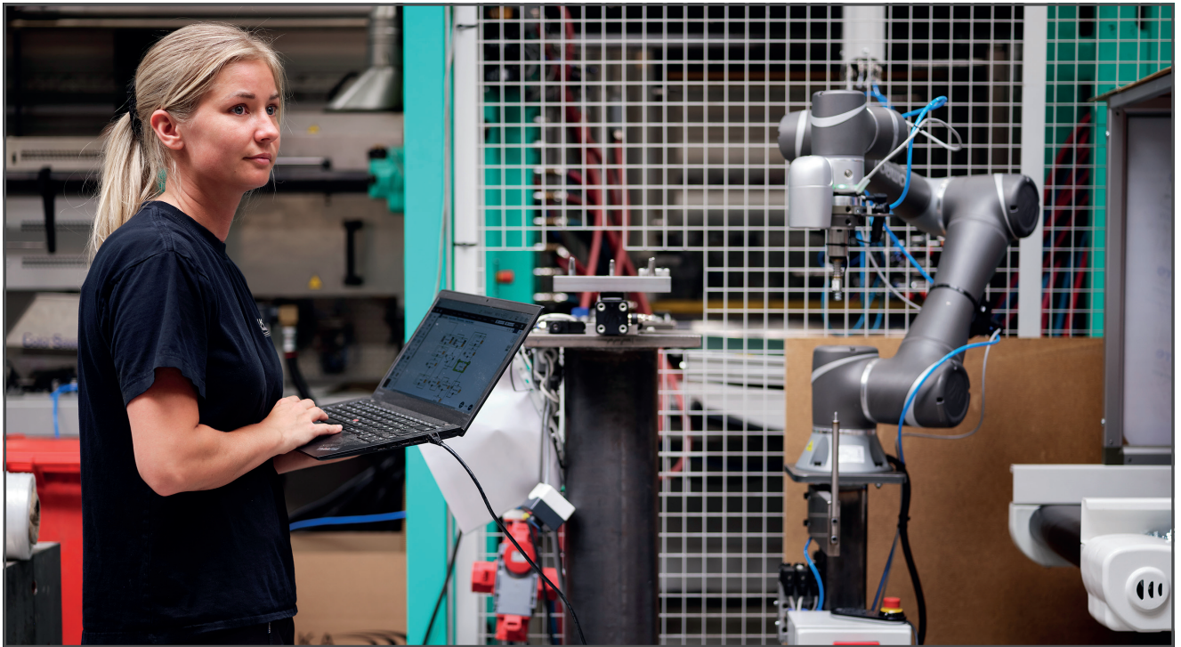
Głównym zastosowaniem wysokiej jakości koboty jest wykrywanie anomalii. Jest to zadanie, które wykonuje nieustraszenie i dokładnie dzięki systemowi wizyjnemu OMRON Landmark.
