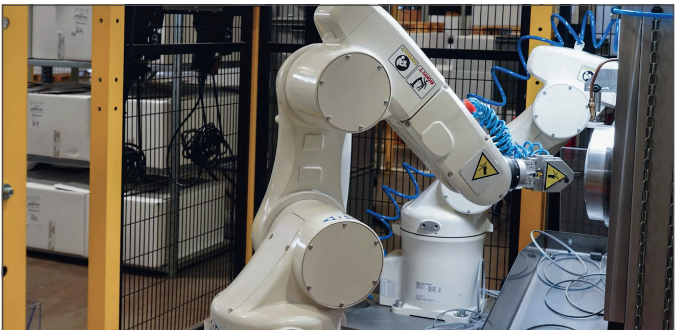
Firma Trelleborg Livorno zmodernizowała stanowisko robota służące do wykańczania uszczelki poliuretanowych stosowanych w sektorze energetyki wiatrowej.
