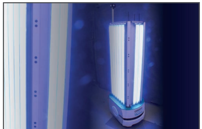
Robot UV-C, który zawiera szereg precyzyjnych lamp UV-C opracowanych przez firmę Phillips i zamontowanych na najnowocześniejszej mobilnej platformie robotów firmy OMRON, samodzielnie odnajduje się w naturalny sposób w obiekcie.
