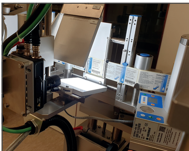
Dzięki systemowi kontroli FHV7 maszyna do etykietowania HERMA w firmie Steierl-Pharma sprawdza tożsamość etykiety na podstawie kodu farmaceutycznego oraz weryfikuje partię i datę ważności.
