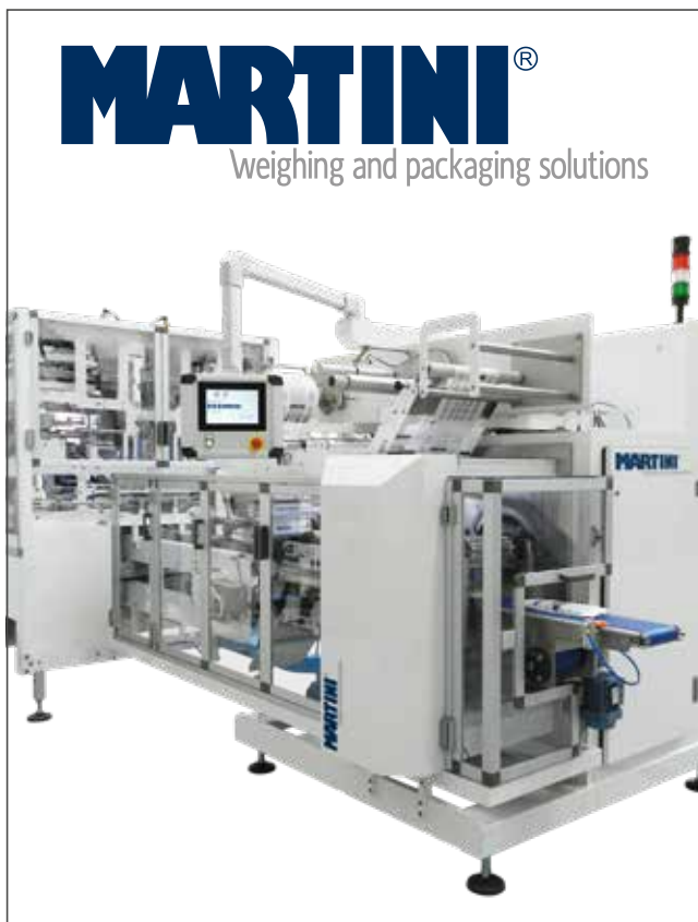
Nowy system HFFS (and. Horizontal Form Fill and Seal) firmy Martini jest o 10% szybszy w zakresie produkcji, częściowo dzięki nowemu sterownikowi maszyn Sysmac NJ501-1400 firmy Omron.
