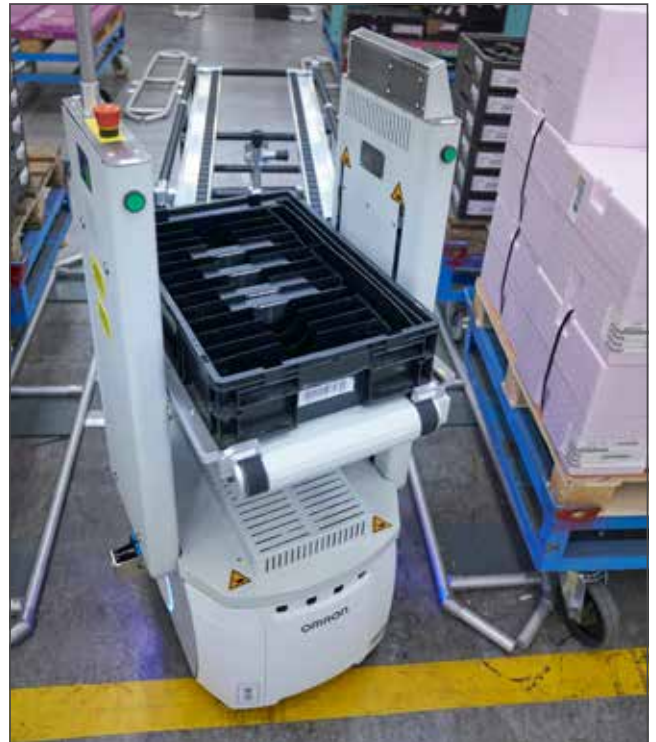
Dostawa małych części odbywa się za pomocą mniejszej wersji urządzenia STR — miniSTR, opartej na robocie mobilnym Omron LD.
