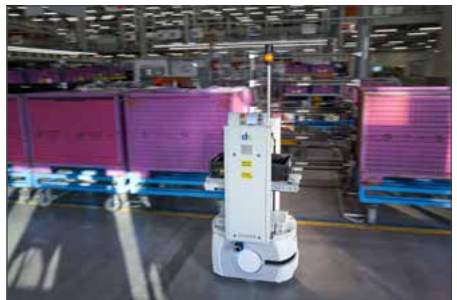
Te autonomiczne roboty mobilne są wyposażone w wieżę przenośnikową — urządzenie do obsługi ładunków o regulowanej wysokości, opracowane przez integratora systemów, firmę cts GmbH.
