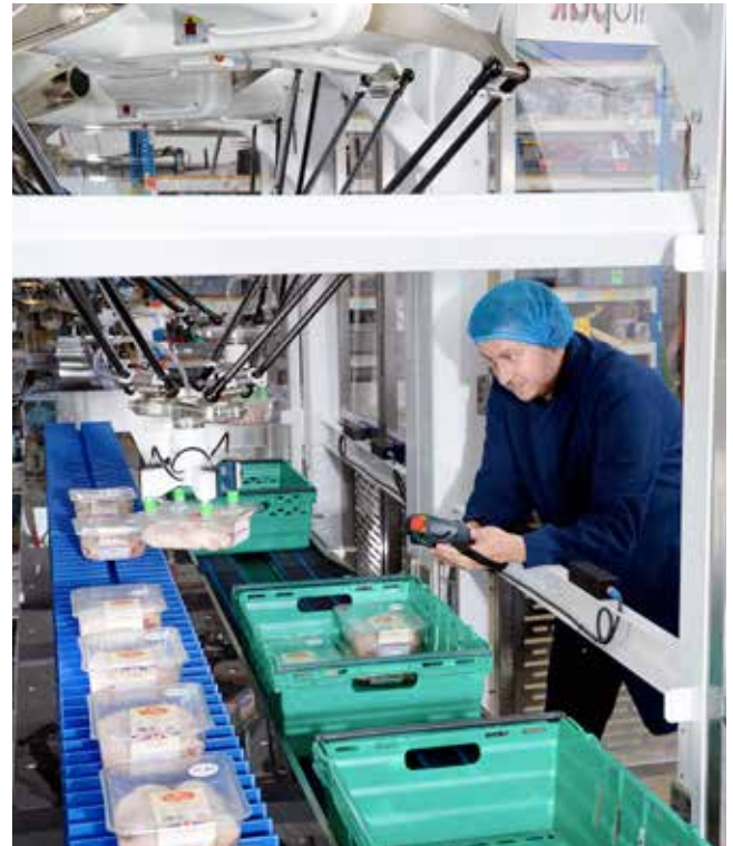
Linjen har to Quattro Delta-roboter, plassert etter hverandre.
