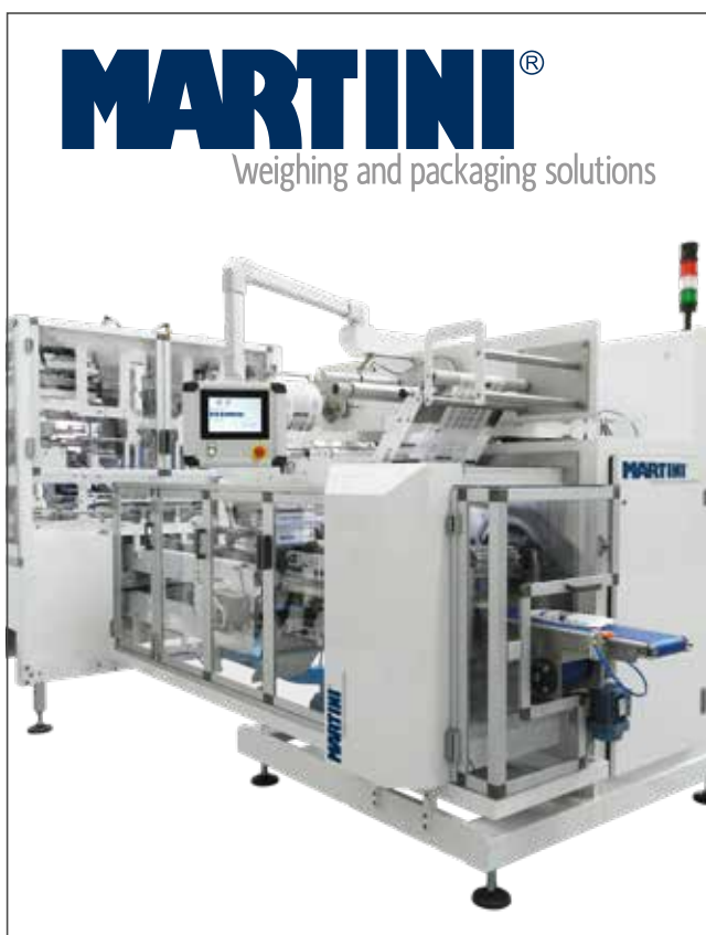
Het nieuwe HFFS-systeem (Horizontal Form Fill and Seal, Horizontaal vormen, vullen en sealen) van Martini is 10% sneller in productie, mede dankzij de nieuwe enkele NJ501-1400 Sysmac machinecontroller van Omron.
