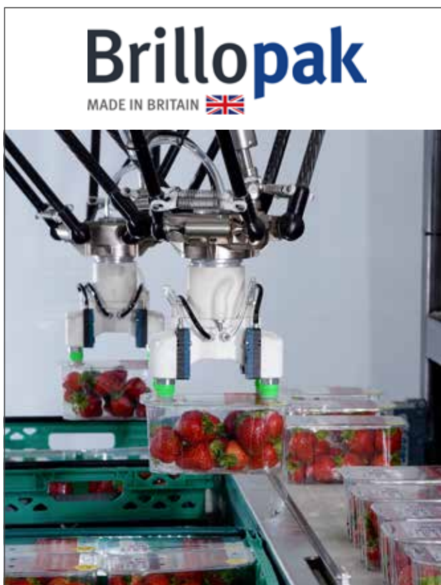
Brillopak heeft een uniek 'single-pick'-concept ontwikkeld dat elke punnet op de juiste plaats in de doos laadt.
