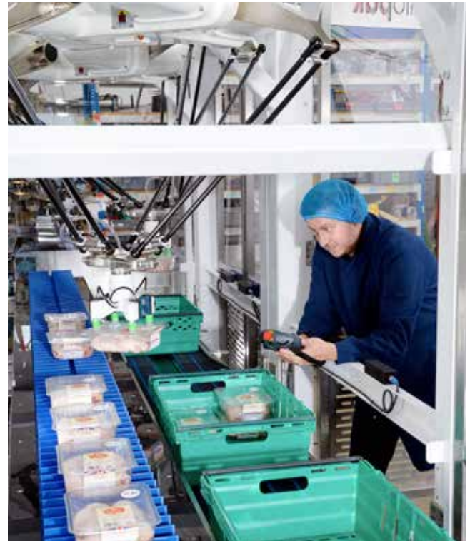
De productielijn beschikt over twee Quattro Delta-robots die achter elkaar zijn geplaatst.
