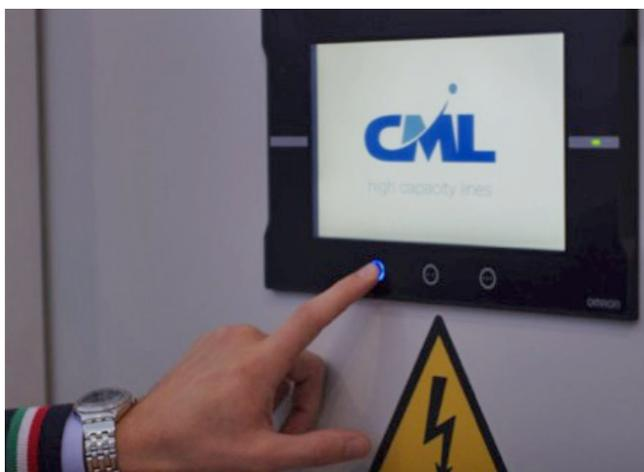
Interfaccia di comando della linea con pannello Operatore Sysmac serie NA
