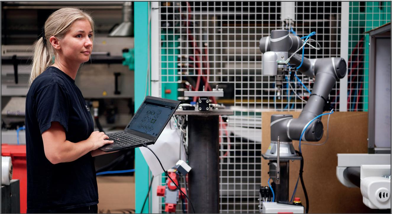
*La funzione principale del cobot di qualità è il rilevamento delle anomalie, un'attività che eseguono in modo instancabile e accurato, grazie al sistema di visione OMRON Landmark.*
