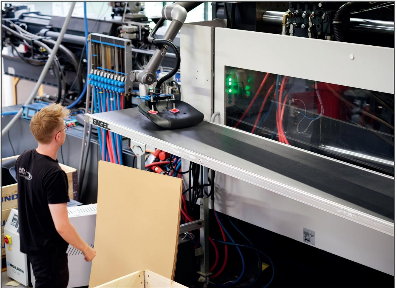
*Utilizzando il sistema di visione integrato, il cobot controlla il posizionamento delle etichette sulla plastica curva.*
