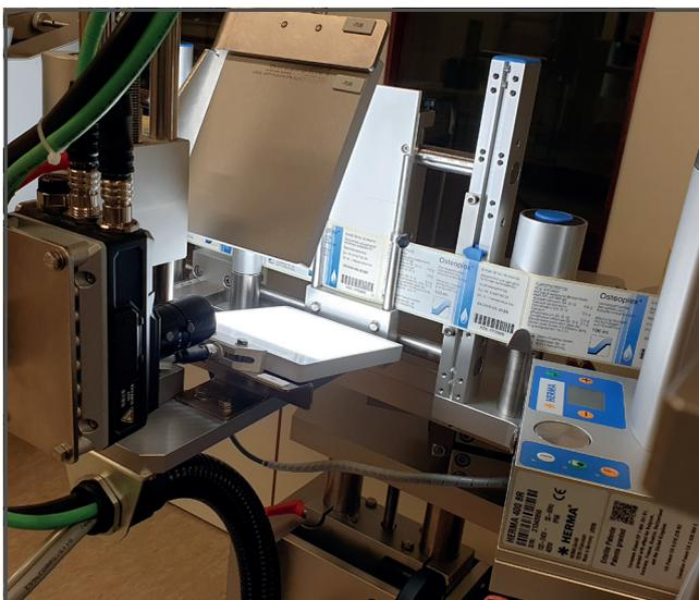
Con l'aiuto del sistema di ispezione FHV7, la macchina per etichettatura HERMA in Steierl-Pharma controlla l'identità dell'etichetta in base al codice farmaceutico e verifica il lotto e la scadenza.
