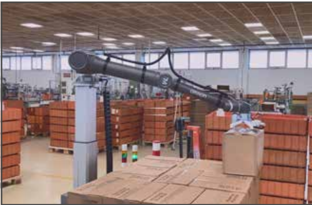
Il nuovo cobot RC-1 ha un raggio d'azione fino a 1300 mm e può sostenere un carico utile fino a 14 kg.
