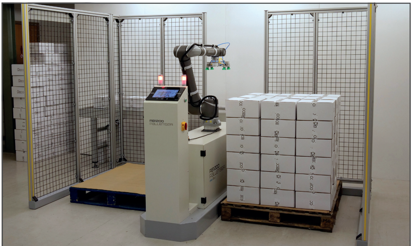
Il RB1200 misura solo 2,2 x 3,2 m, il che equivale a una riduzione delle dimensioni del 60% rispetto a un tipico pallettizzatore cartesiano 4x4 m.
