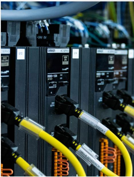
Per garantire processi rapidi e precisi, sono stati impiegati 15 servoazionamenti OMRON 1S con un tempo di ciclo di appena 0,5 ms, che ha permesso di completare le operazioni di confezionamento
