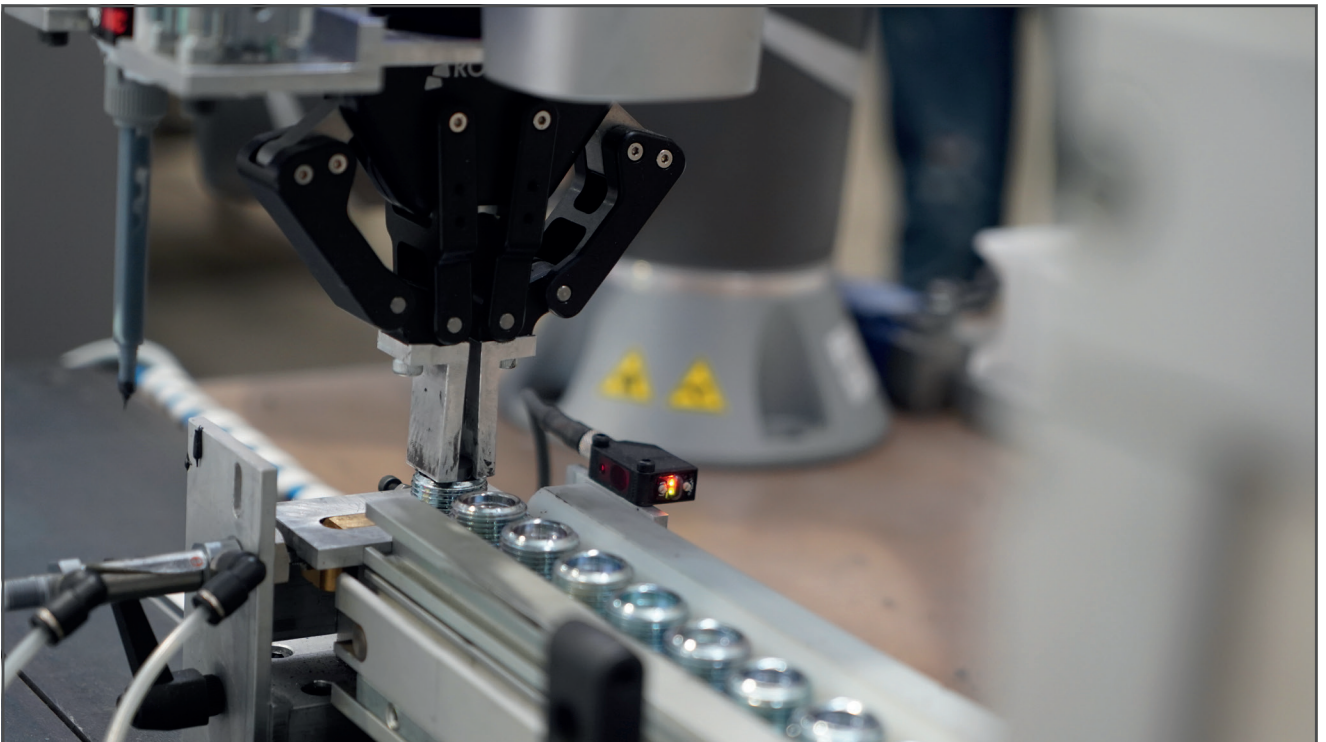
Il Cobot esercita sempre la stessa pressione del magnete sul tappo, assicurando ripetibilità e qualità coerente al risultato finale.
