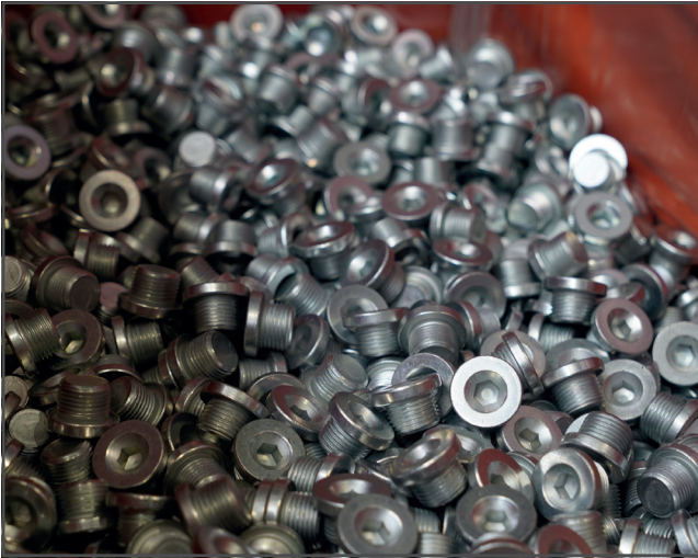
L'applicazione consente a Litmat di assemblare circa 180 tappi/ora per un totale di circa 1500 pezzi per ogni turno di lavoro.
