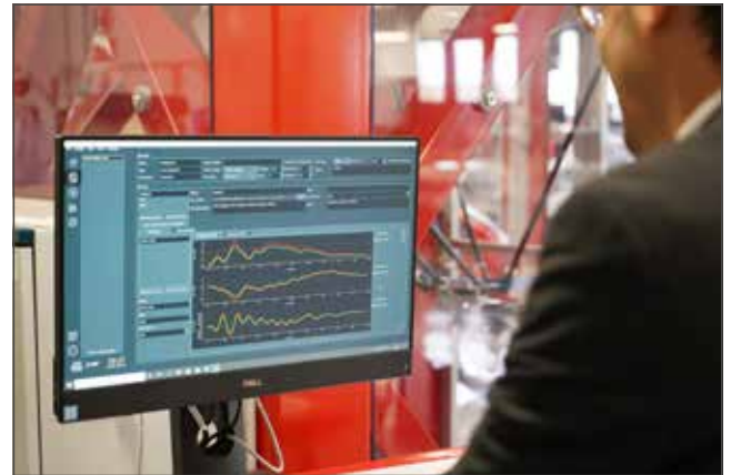
Si tratta di una soluzione basata sull'utilizzo di un robot Delta Quattro Adept di Omron, programmato per sottoporre le scatole nere alle stesse accelerazioni e decelerazioni che verrebbero registrate su un'autovettura durante un crash test.
