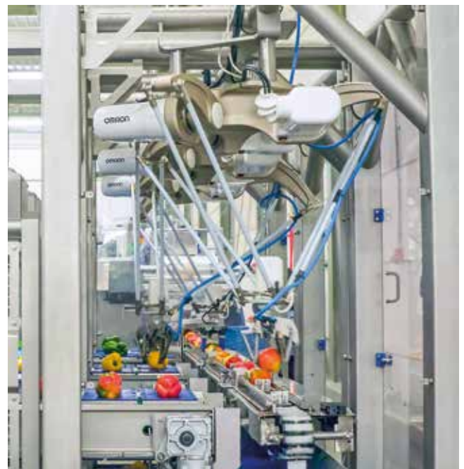
"Abbiamo utilizzato tre robot Omron in una variante impermeabile che può essere lavata accuratamente".
