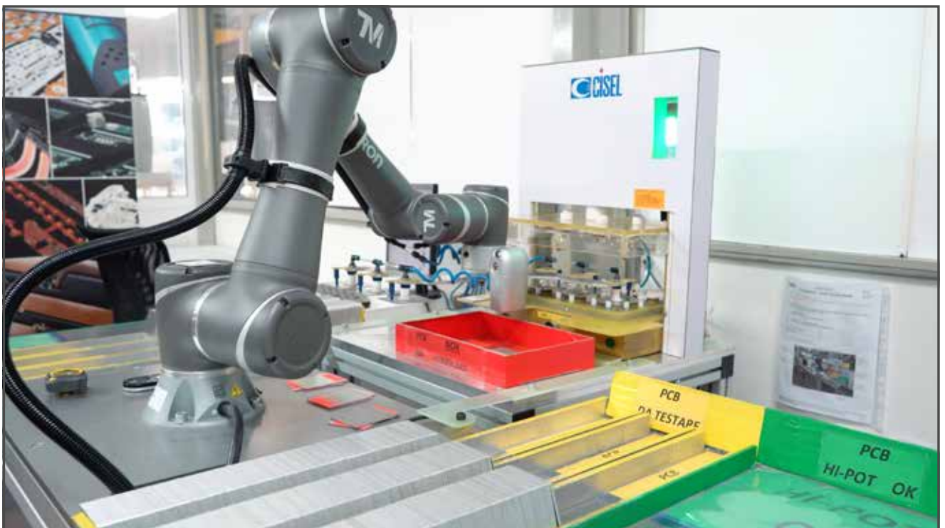
Cisel ha scelto un Cobot OMRON per automatizzare i test elettrici delle schede destinate all'impianto servosterzo di un noto produttore automobilistico.
