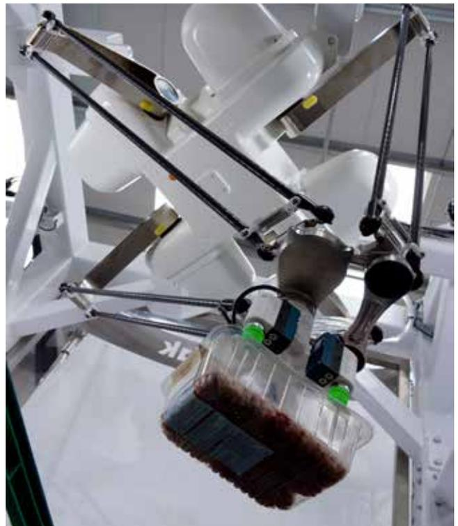
*La linea utilizza il software PackXpert di Omron, che consente di programmare il posizionamento e l'ordine di confezionamento delle singole vaschette.*
