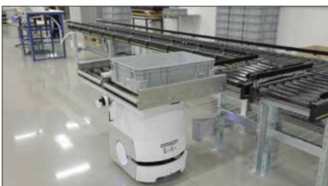
Les robots LD d'OMRON ont remplacé les convoyeurs à rouleaux, pour une configuration de production et de logistique plus flexible.
