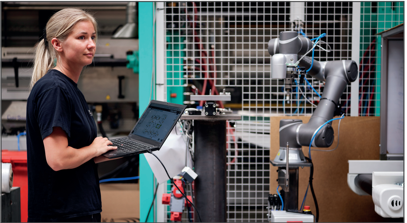
La fonction principale du cobot de contrôle qualité est la détection des anomalies, une tâche qu'il effectue sans relâche et avec précision, grâce au système de vision Landmark OMRON.
