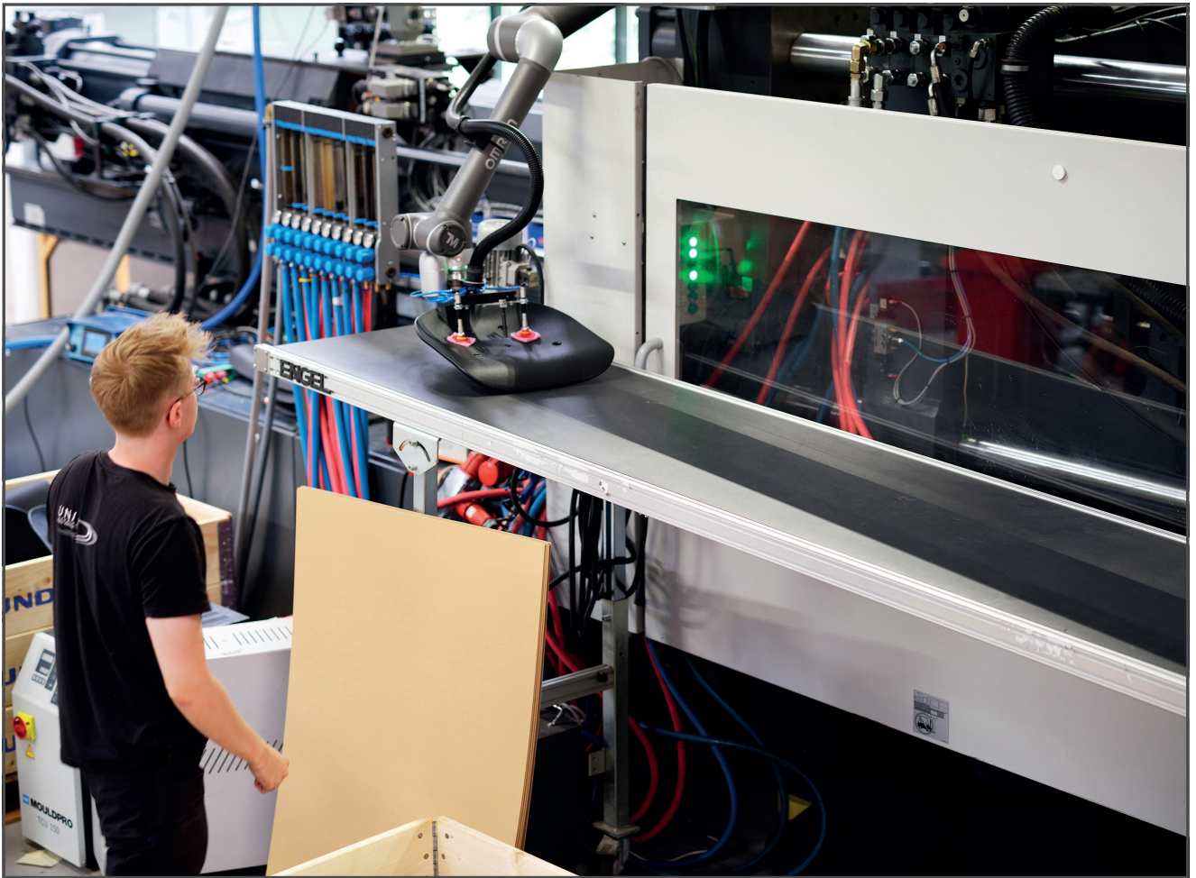
Grâce à son système de vision intégrée, le cobot vérifie le positionnement de l'étiquetage sur le plastique incurvé.
