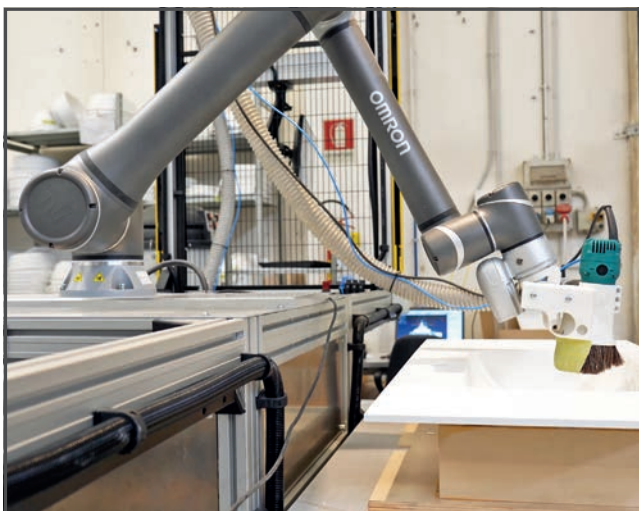
Le nouveau cobot automatise toutes les opérations de finition des produits de Topcustom fabriqués en Ocritech.
