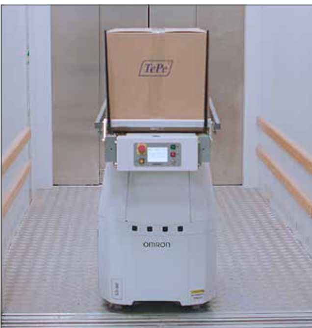
Les robots mobiles transportent les articles entre les différentes machines, ainsi qu'entre le stock et la ligne de fabrication.
