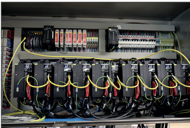
La base de cette solution de retrofit est la plate-forme d'automatisation Sysmac, associée aux moteurs 1S de OMRON avec une intégration en continu du contrôleur de machine de série NX/NJ vers le logiciel.
