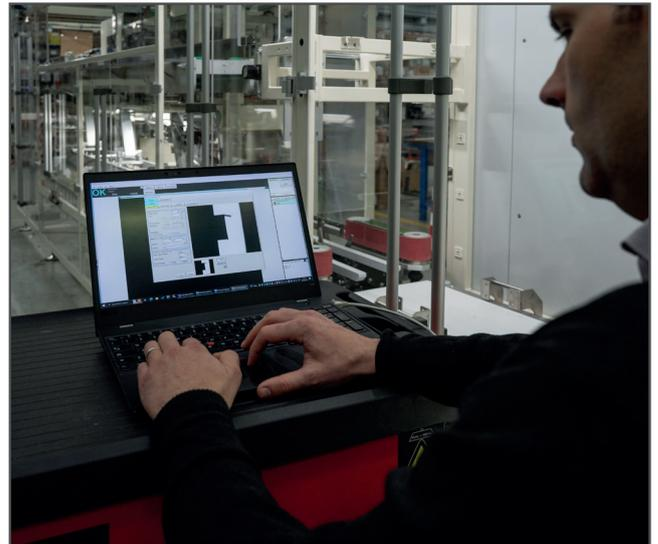
faisait intervenir un **contrôleur FH-2050-10** capable de se connecter simultanément à trois caméras : deux VGA et une troisième caméra haute résolution pour la lecture précise des numéros de lots et des dates d'expiration.
