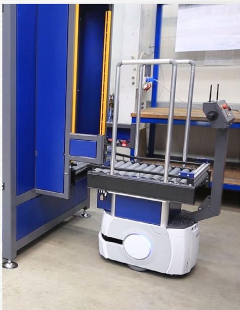
La fonction Déplacement précis permet au robot de se placer très précisément devant le tapis du convoyeur. De plus, elle contrôle les processus de démarrage et de freinage en douceur, ce qui est essentiel lors du transport de matériaux fragiles et coûteux.
