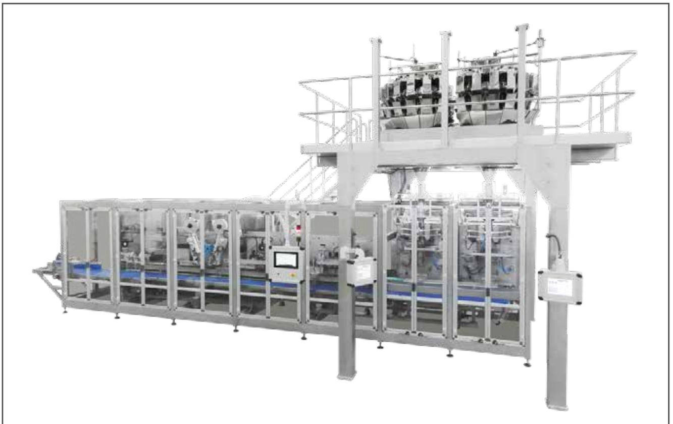
*Le nouveau système de conditionnement MCRS-VD permet de conditionner jusqu'à 180 paquets de pâtes par minute.*
