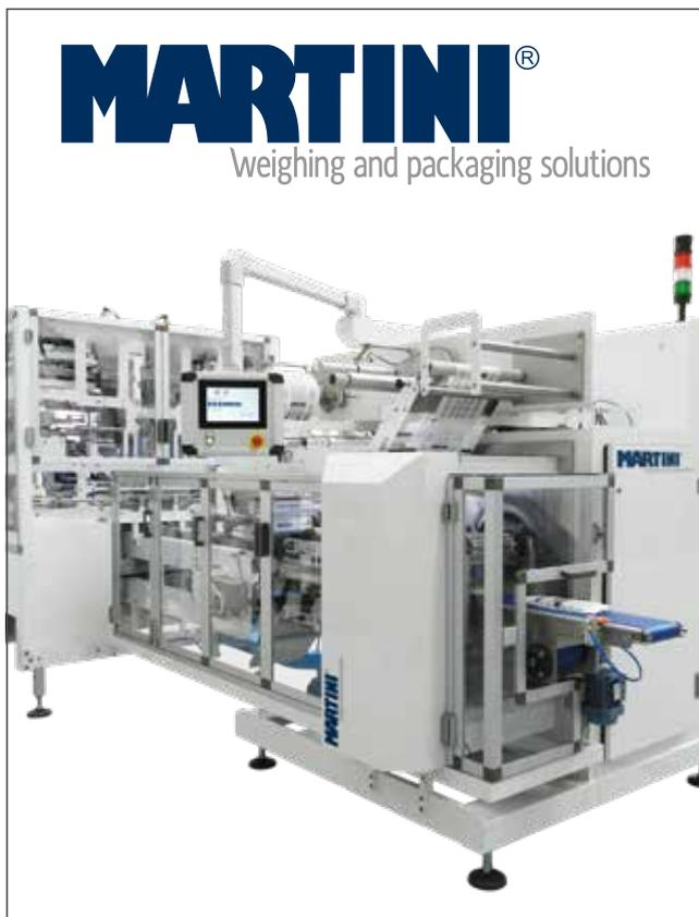
*Le nouveau système de moulage, remplissage et scellage horizontal (Horizontal Form Fill and Seal, HFFS) est 10 % plus rapide lors de la production, en partie grâce au nouveau contrôleur de machine Sysmac NJ501-1400 unique d'Omron.*
