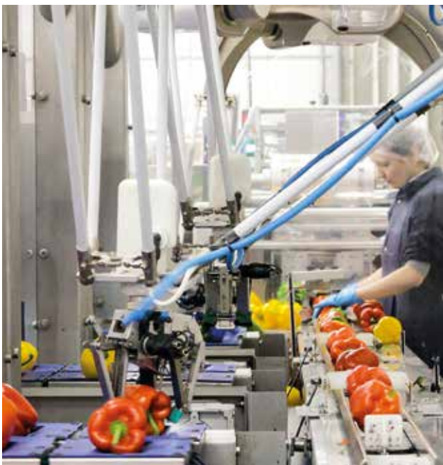
Les robots ramassent les poivrons et les positionnent correctement sur la courroie selon un ordre de couleur prédéfini.
