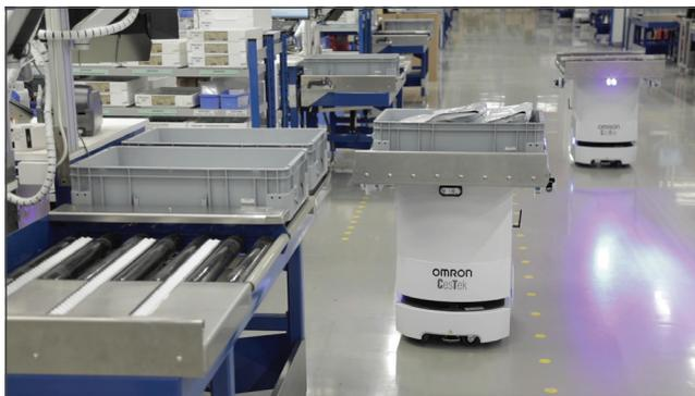
En uno de los proyectos con robots móviles industriales más ambiciosos de todo el norte de Europa, VOLA puso en marcha una flota de nueve robots LD de OMRON. Los robots se adquirieron como sustitución de los transportadores de rodillos, lo que les permitió obtener una producción y una logística más flexibles, adaptada al proceso de producción de piezas únicas de la empresa, en el que todo se produce bajo pedido.
