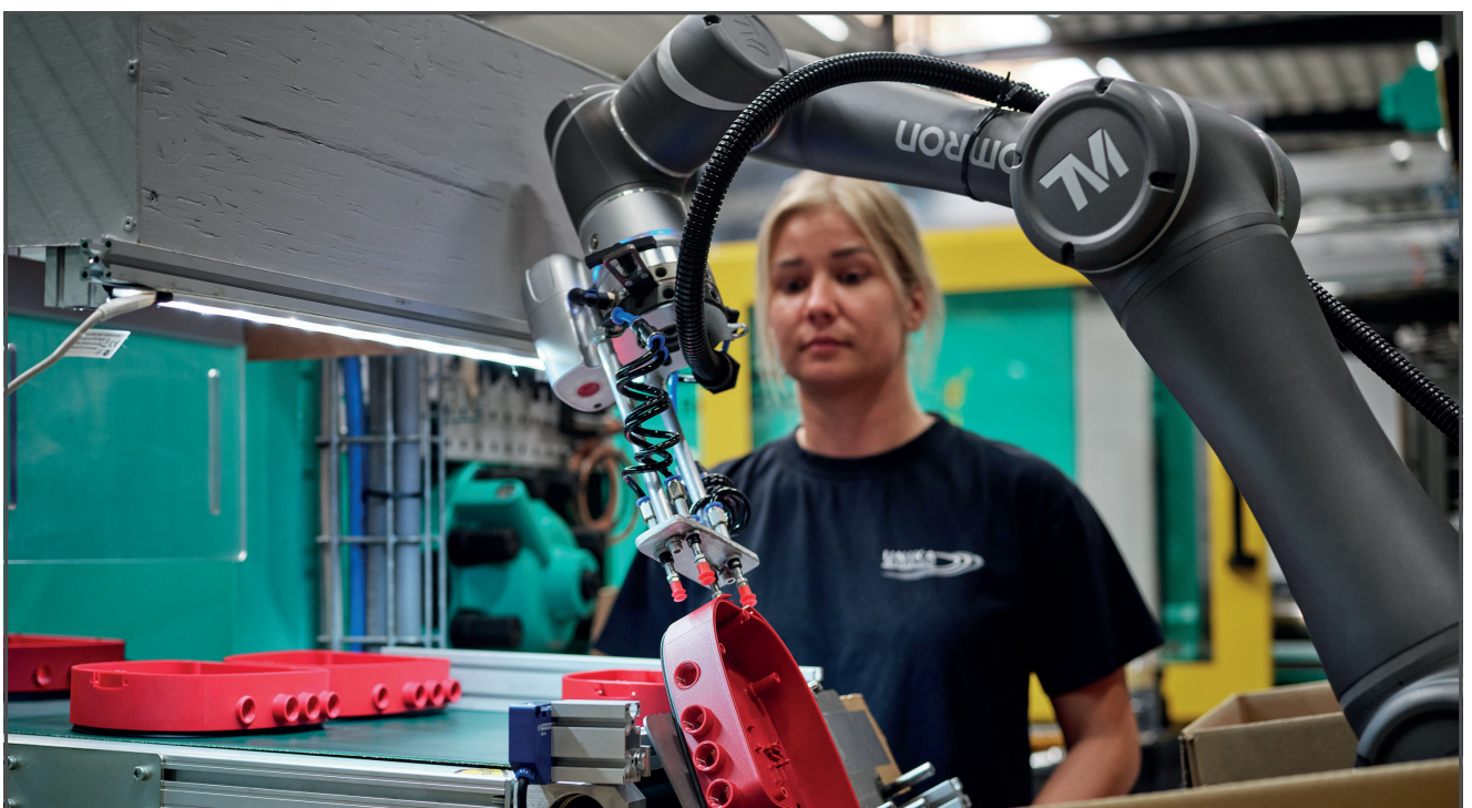
Unika cuenta con tres cobots TM de OMRON que trabajan en la planta y realizan diversas tareas junto con el equipo de operaciones.
