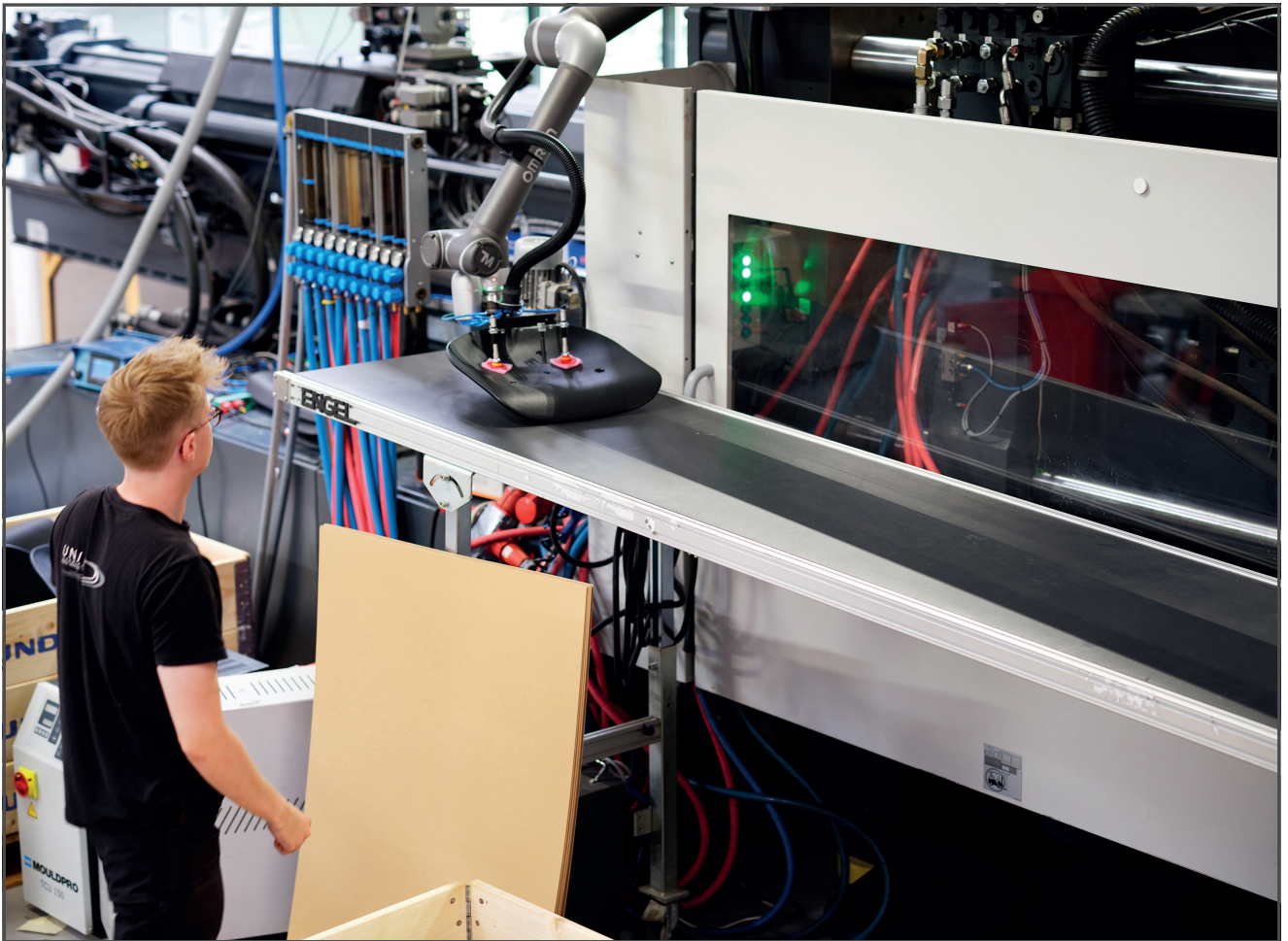
Gracias a su sistema de visión integrado, el cobot comprueba la colocación del etiquetado en el plástico curvado.
