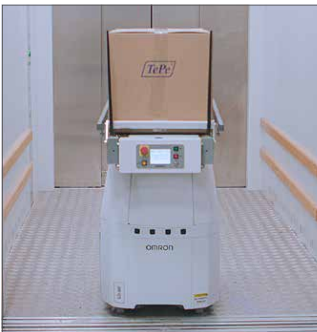
Los robots móviles transportan objetos entre las distintas máquinas, así como desde el almacén hasta la línea de producción.
