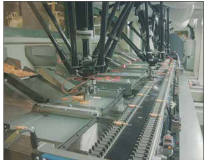
Una línea de alta velocidad, compuesta por cinco robots industriales, dos robots móviles y diez sistemas de visión, permite a TePe alcanzar un rendimiento nueve veces superior y personalizar el envasado en cuestión de segundos.
