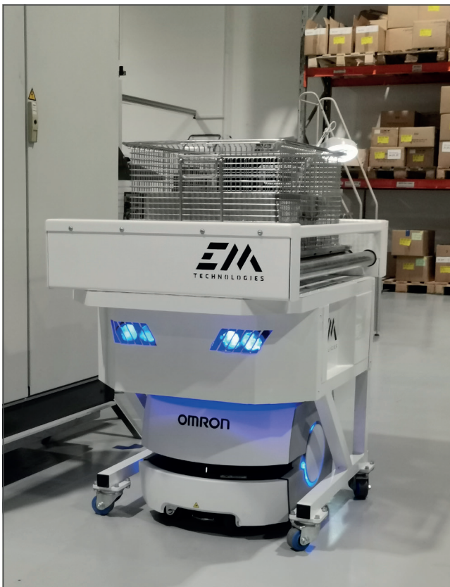
Philips automatiza el transporte de materiales mediante unidades AMR.
