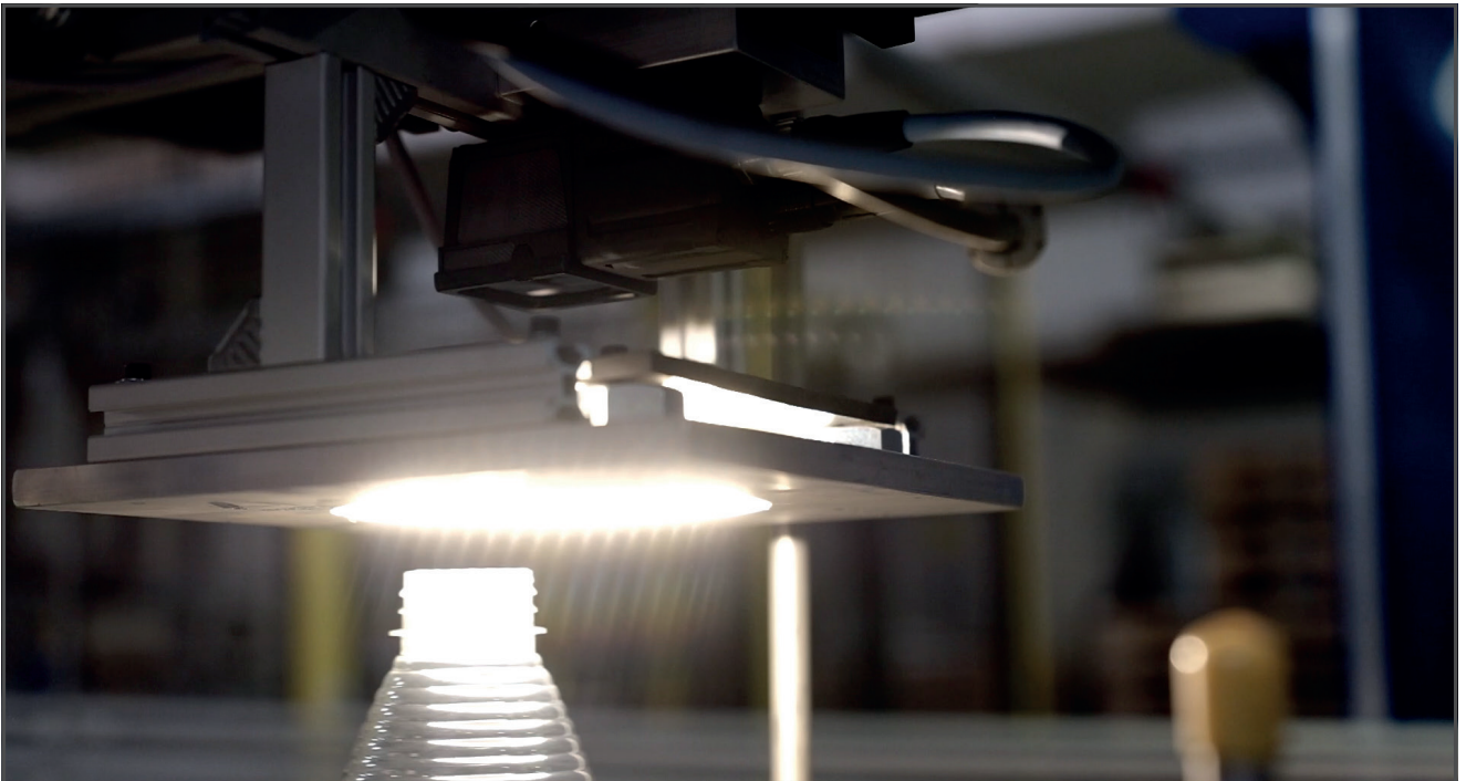
El sistema de OMRON se utiliza en la línea de producción e incorpora luces y cámaras colocadas en diferentes ángulos que permiten detectar cualquier defecto.
