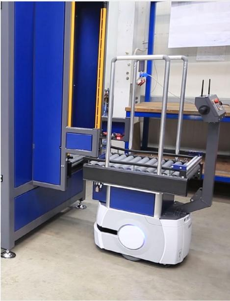
En la función Precision Drive, el robot se coloca con gran precisión delante de la cinta transportadora. Además, puede arrancar y frenar con suavidad, lo que es crucial a la hora de transportar materiales frágiles y caros
