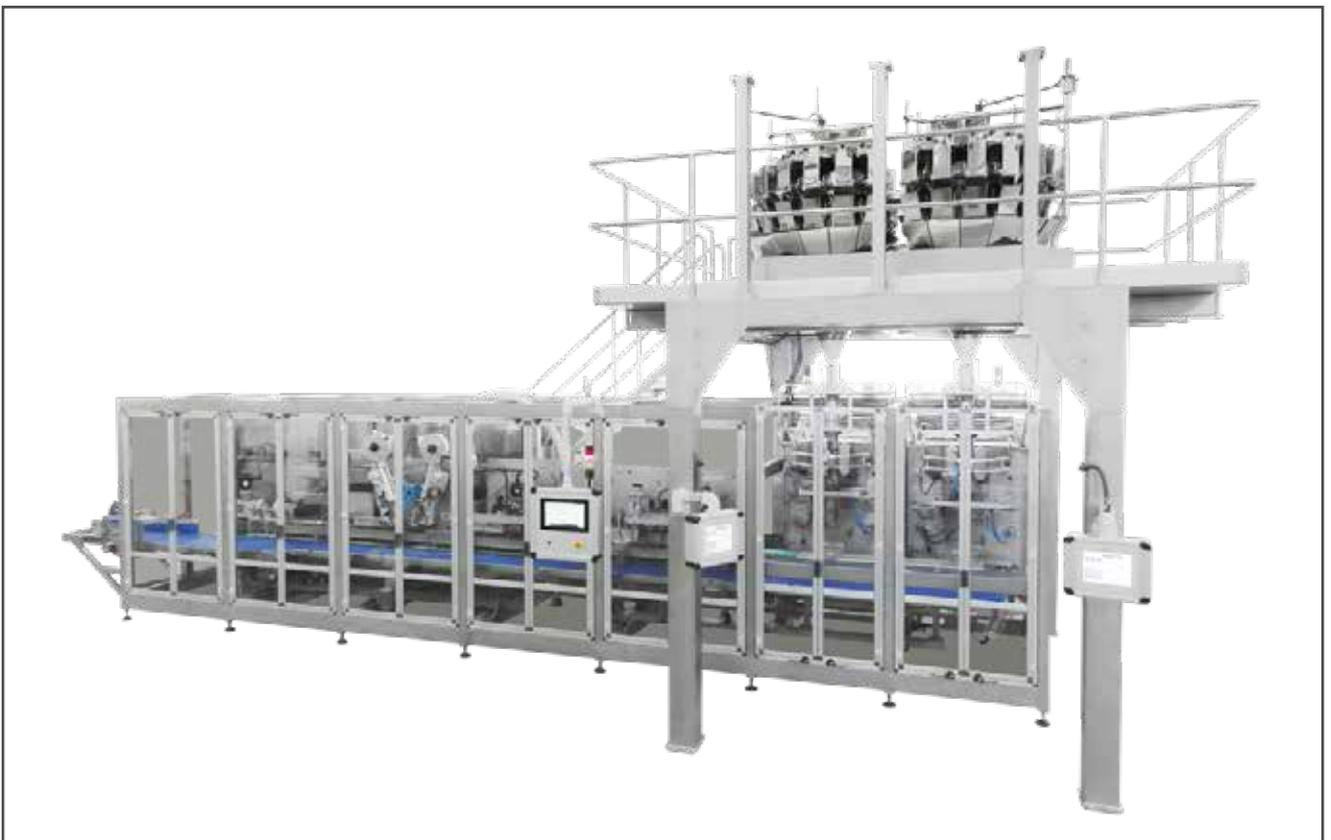
*El MCRS-VD automatiza todas las etapas del proceso de embalaje, incluido el plegado, el sellado y el etiquetado.*
